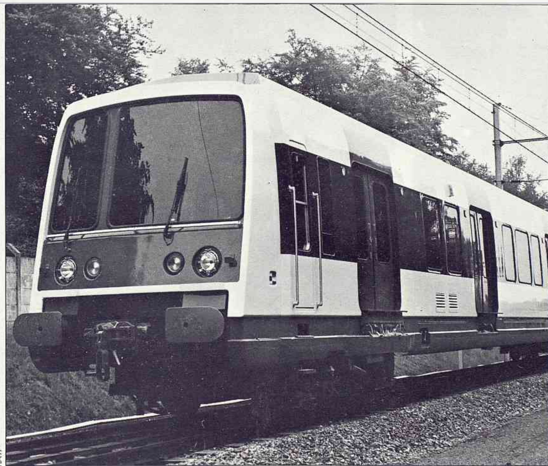
Le prototype du matériel MI 79, livré à l'atelier de Massy-Palaiseau, est actuellement en cours d'essais intensifs sur une voie spéciale.
