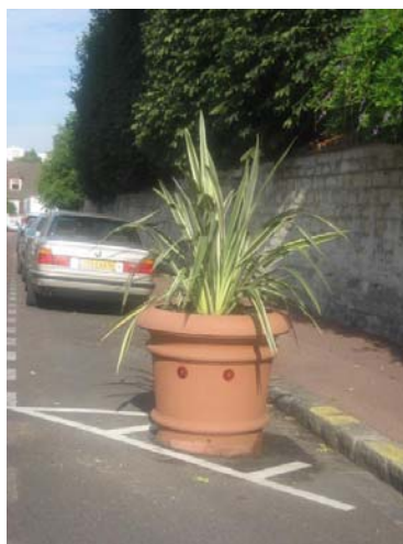
Aménagements simples dans les zones 30 : matérialisation des emplacements de stationnement en chicane, mise en place d'obstacles
